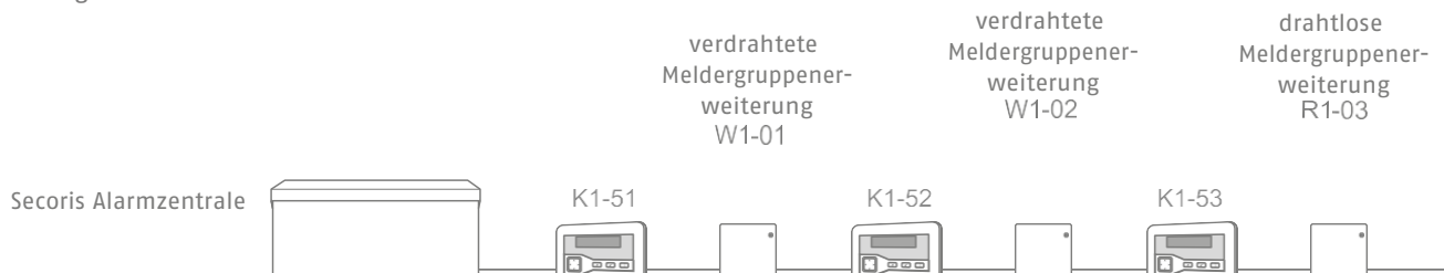
Abbildung 1: Beispiel für Busgeräteadressierung
